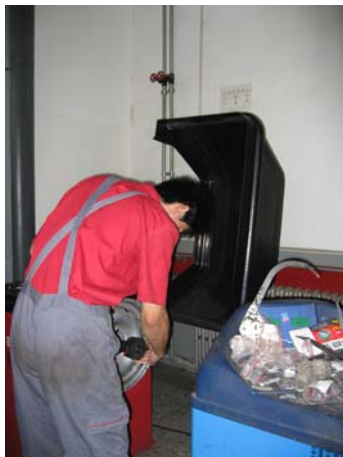
圖三、工作人員使用車輪平衡器檢查車輪是否平衡
